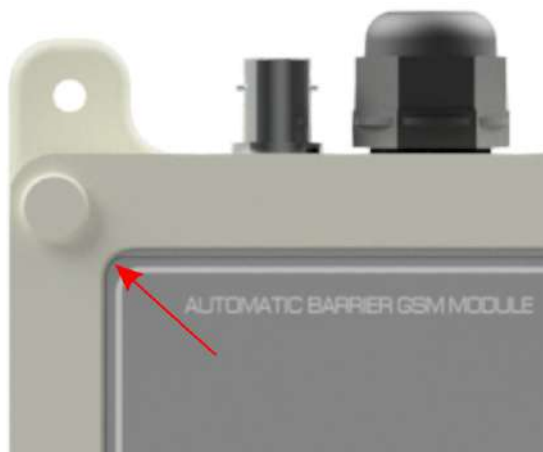
Рисунок 4.4.1 Расположение винтов корпуса модуля.
