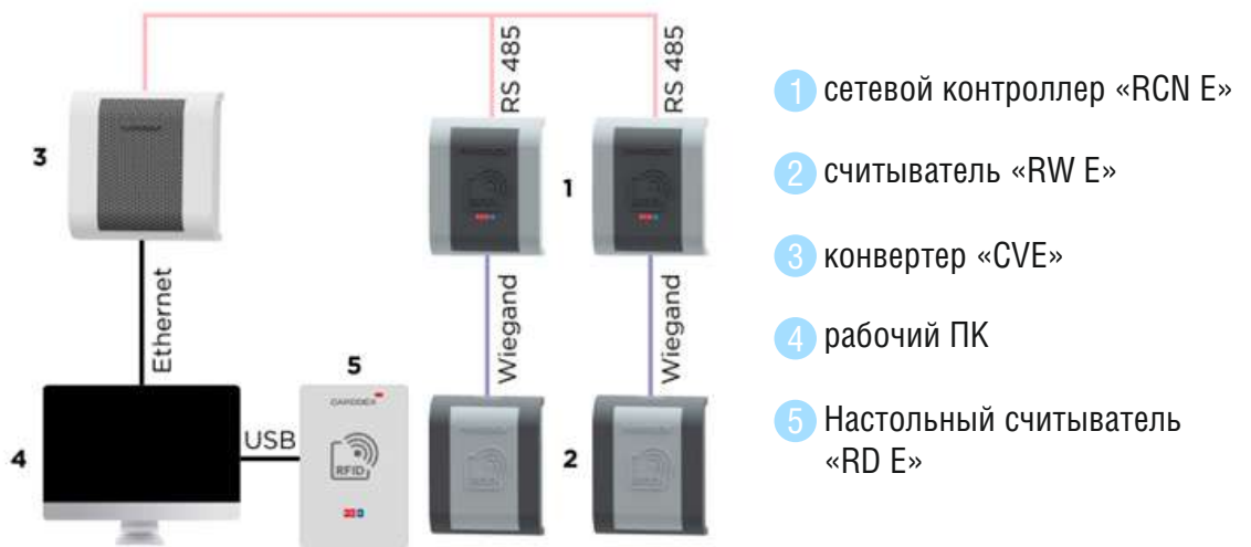
Рисунок 2.2 Схема подключения через преобразователь «CVE»
