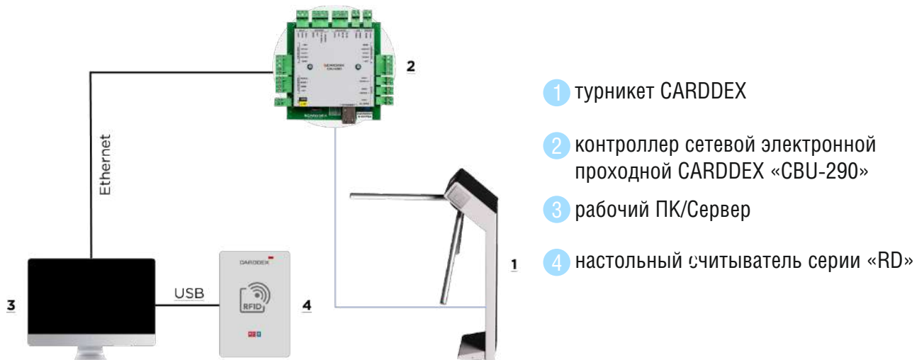
Рисунок 2.4 Схема подключения турникета на базе платы управления СВU-290
