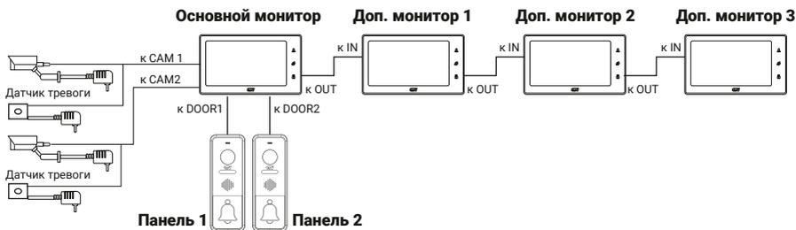
Вызывные панели подключаются только к основному монитору.
