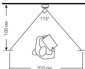
Угол обзора по горизонтали составляет 115°, по вертикали – 63°, что позволяет обеспечить зону наблюдения шириной 310 см и высотой 122 см на расстоянии 100 см от панели.
